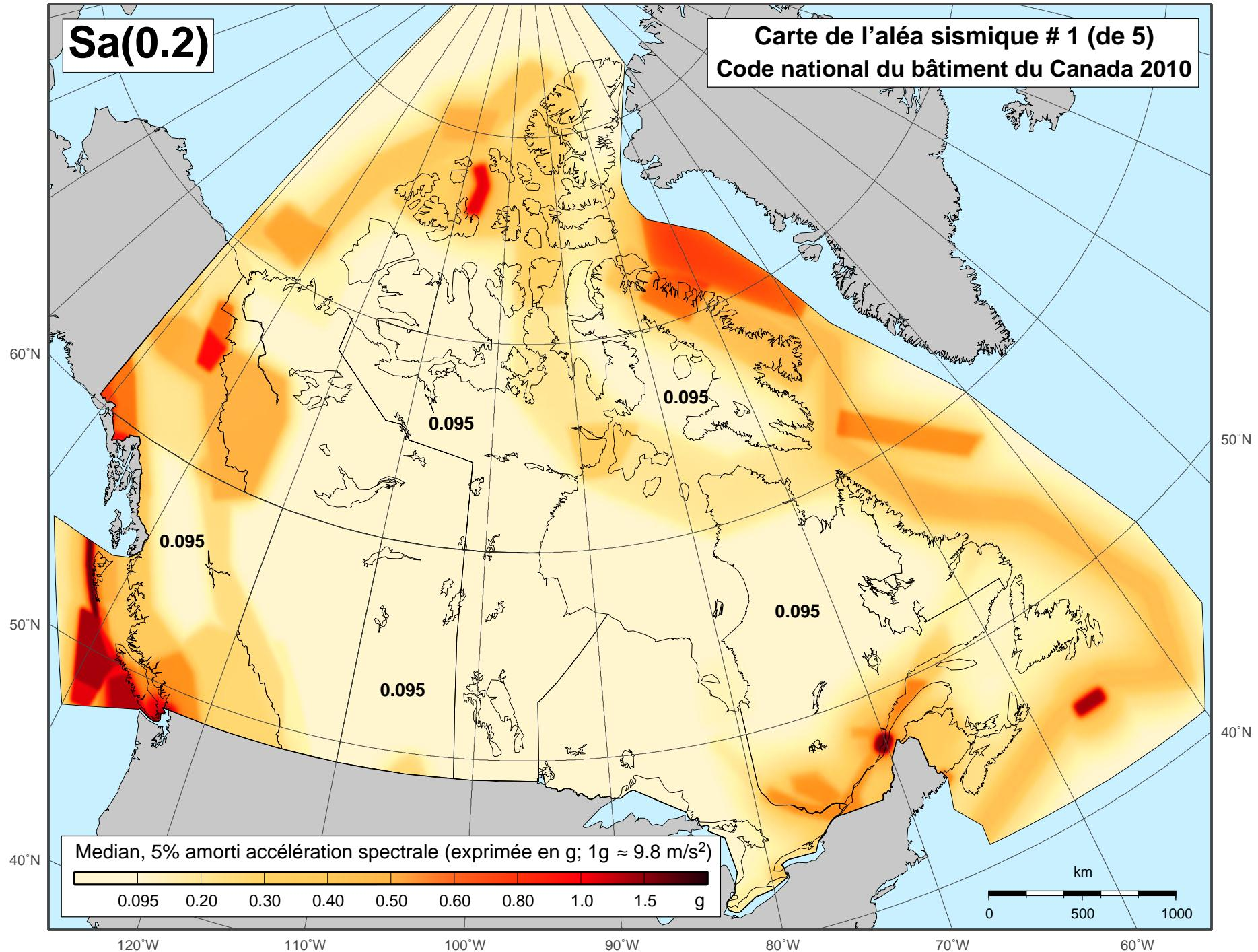
Accélération spectrale dans un terrain ferme (sol de class C du CNBC) pour une période de 0.2 seconde et une probabilité de 2% sur 50 ans.
