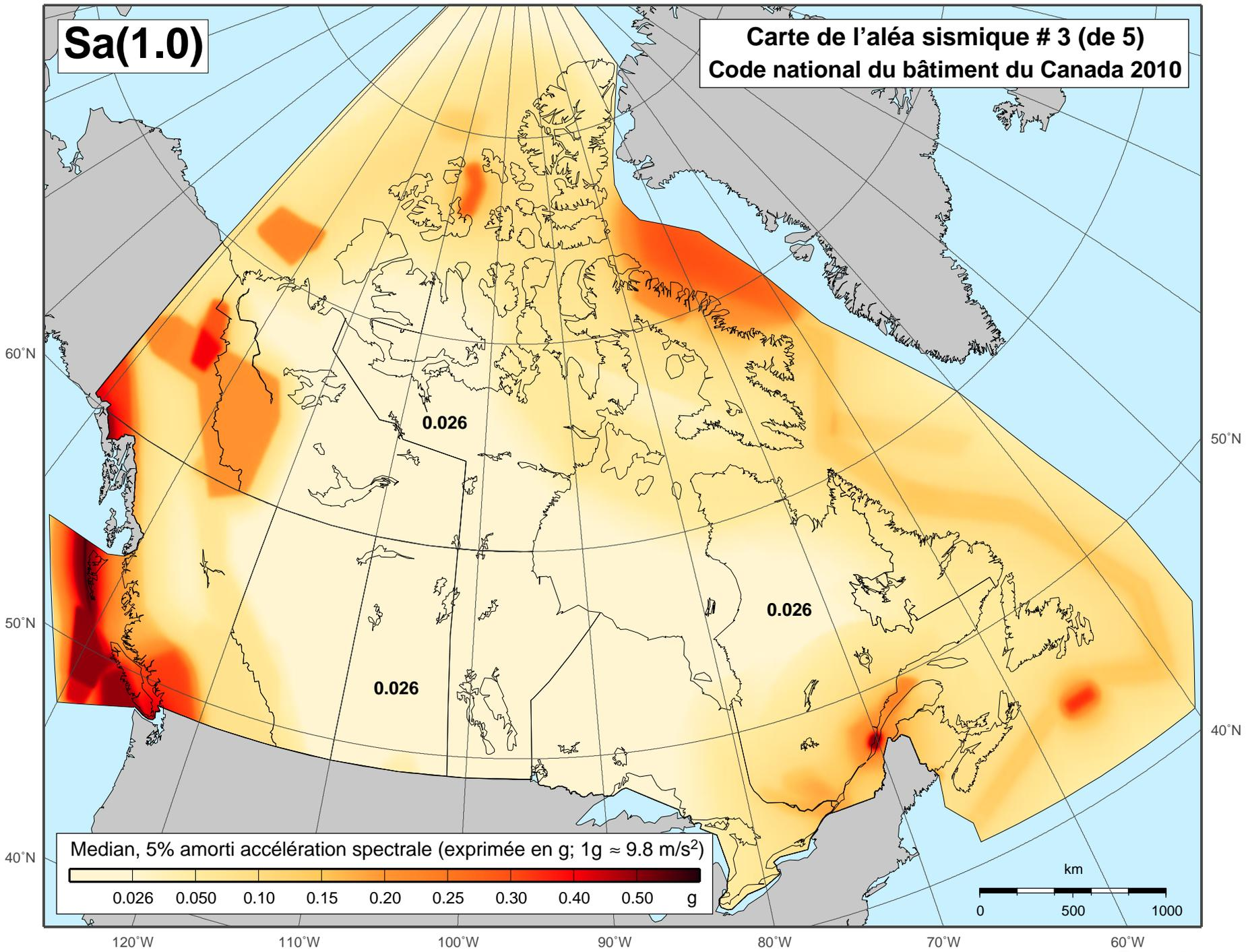
Accélération spectrale dans un terrain ferme (sol de class C du CNBC) pour une période de 1.0 seconde et une probabilité de 2% sur 50 ans.
